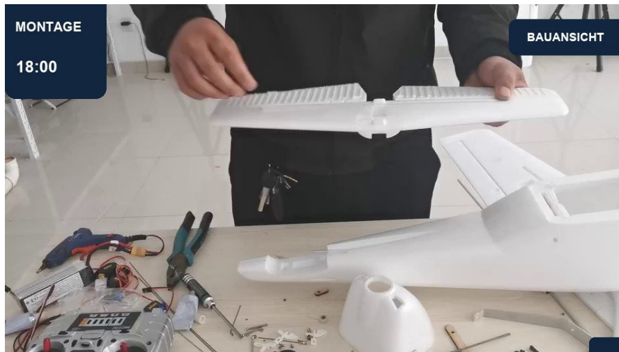
18:00 | Höhenleitwerk und Scharniere | Ansicht 1
