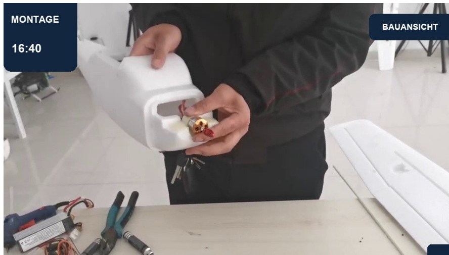
16:40 | Antrieb in die Rumpfnase setzen | Ansicht 1
