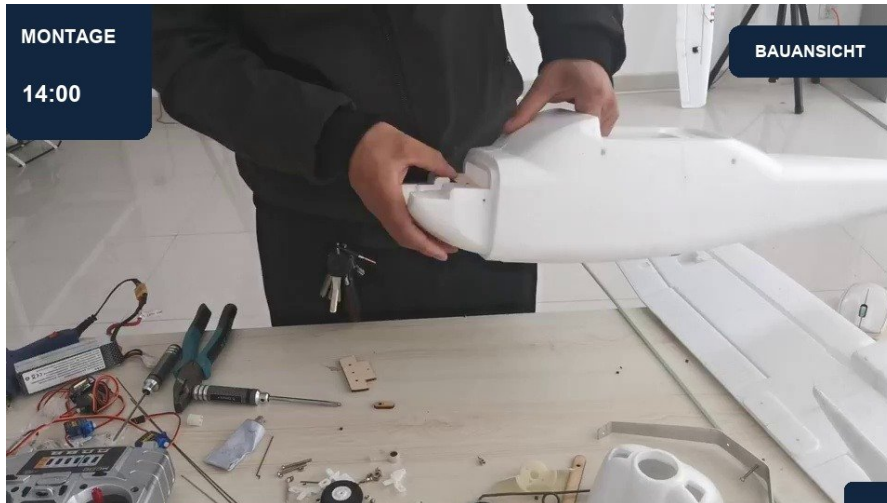
14:00 | Bugfahrwerksaufnahme verstärken | Ansicht 1
