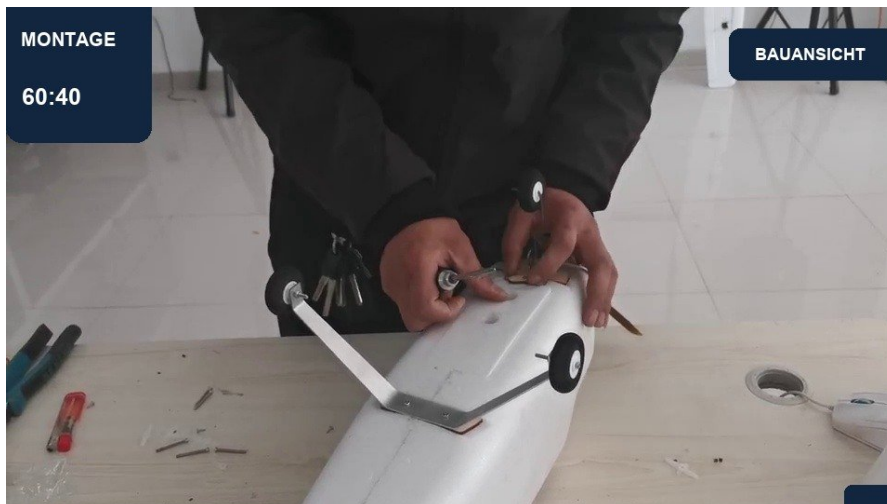
60:40 | Haupträder einsetzen | Ansicht 2
