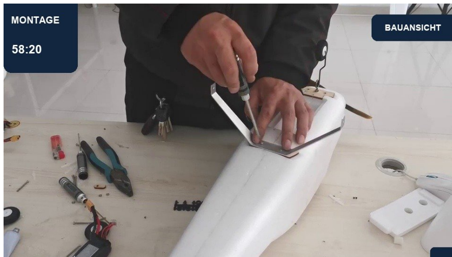
58:20 | Hauptfahrwerksbügel befestigen | Ansicht 2
