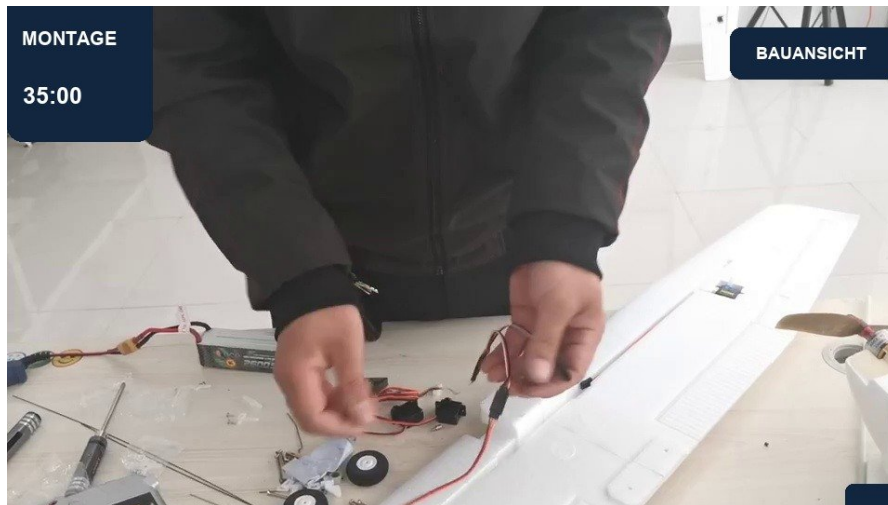
35:00 | Querruderkabel verlegen | Ansicht 1
