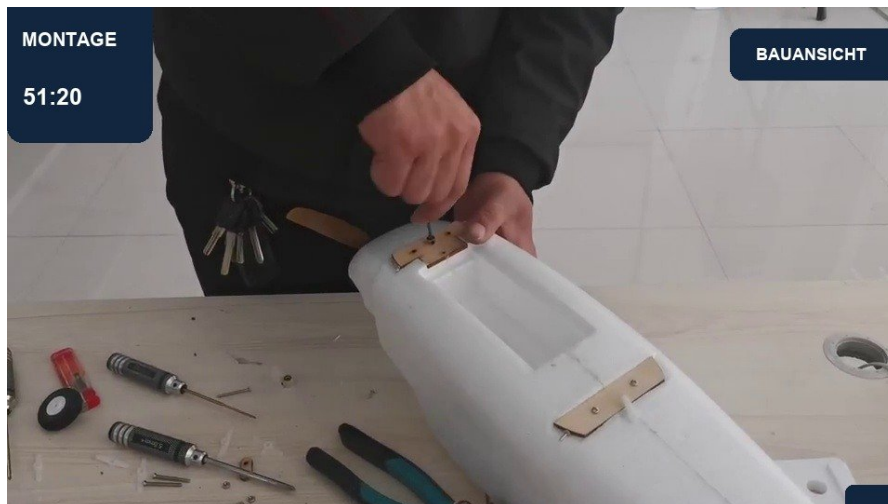
51:20 | Bugfahrwerkslager montieren | Ansicht 2
