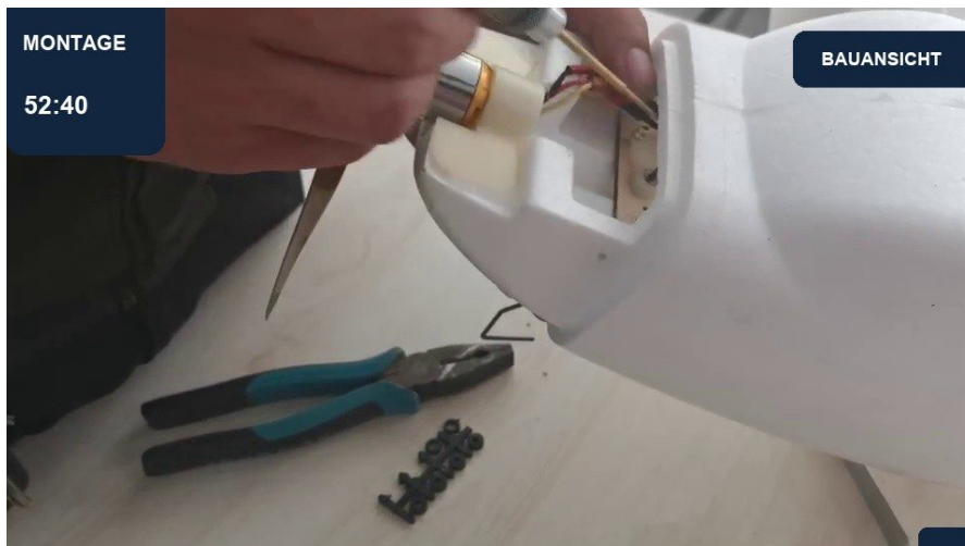
52:40 | Bugfahrwerksdraht und Lenkhebel | Ansicht 2
