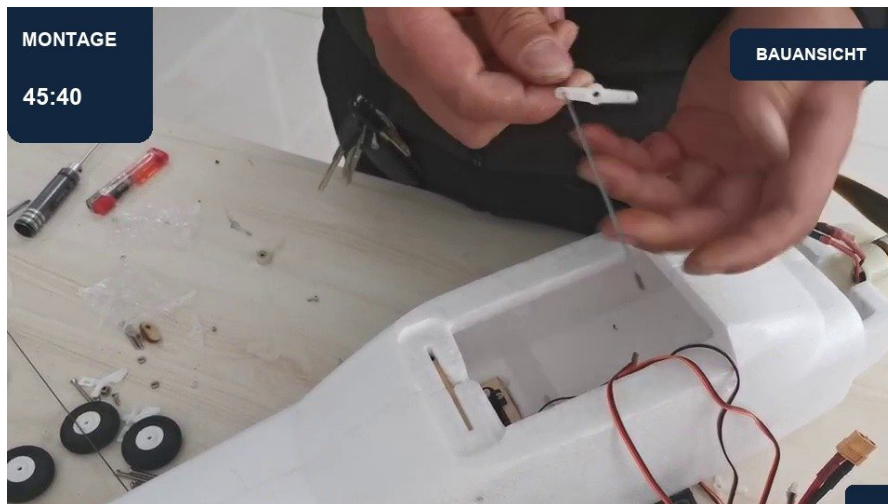
45:40 | Lange Heckgestänge einziehen | Ansicht 2
