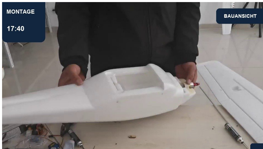
17:40 | Antrieb in die Rumpfnase setzen | Ansicht 2
