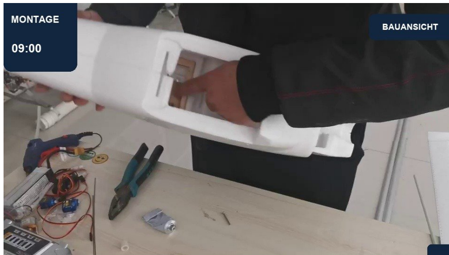
09:00 | Innere Rumpfverstärkung einkleben | Ansicht 1
