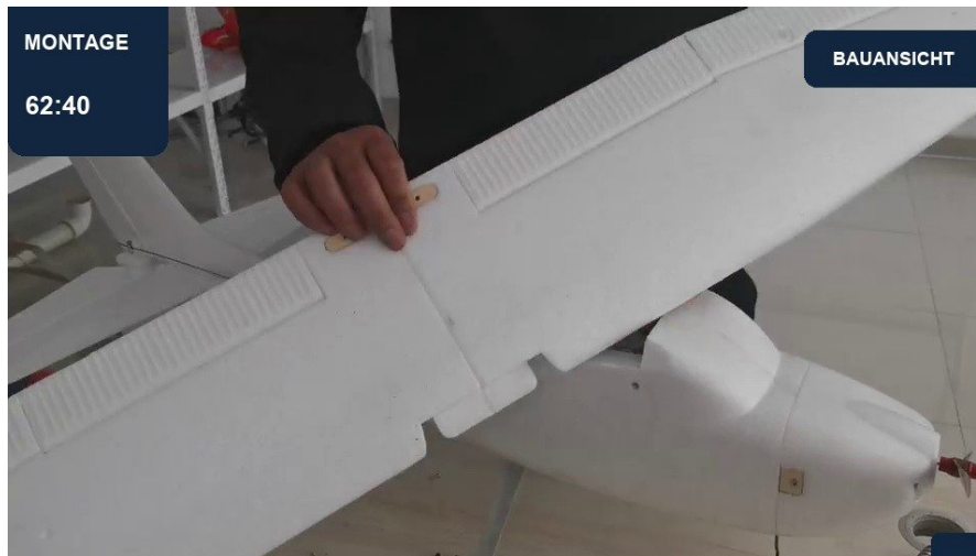
62:40 | Tragfläche auf dem Rumpf befestigen | Ansicht 1
