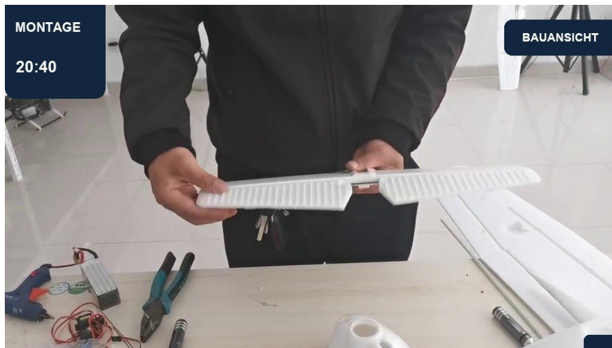
20:40 | Höhenleitwerk versteifen | Ansicht 2
