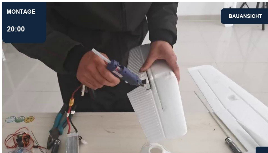
20:00 | Höhenleitwerk versteifen | Ansicht 1
