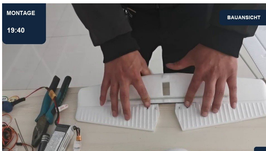
19:40 | Höhenruderhälften verbinden | Ansicht 2
