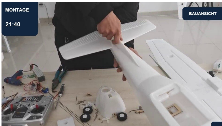
21:40 | Leitwerke trocken ausrichten | Ansicht 2
