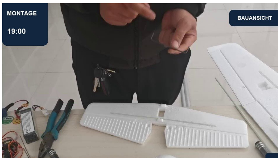
19:00 | Höhenruderhälften verbinden | Ansicht 1
