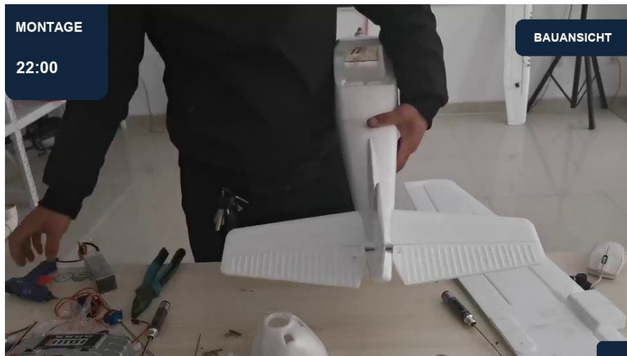
22:00 | Leitwerke dauerhaft verkleben | Ansicht 1
