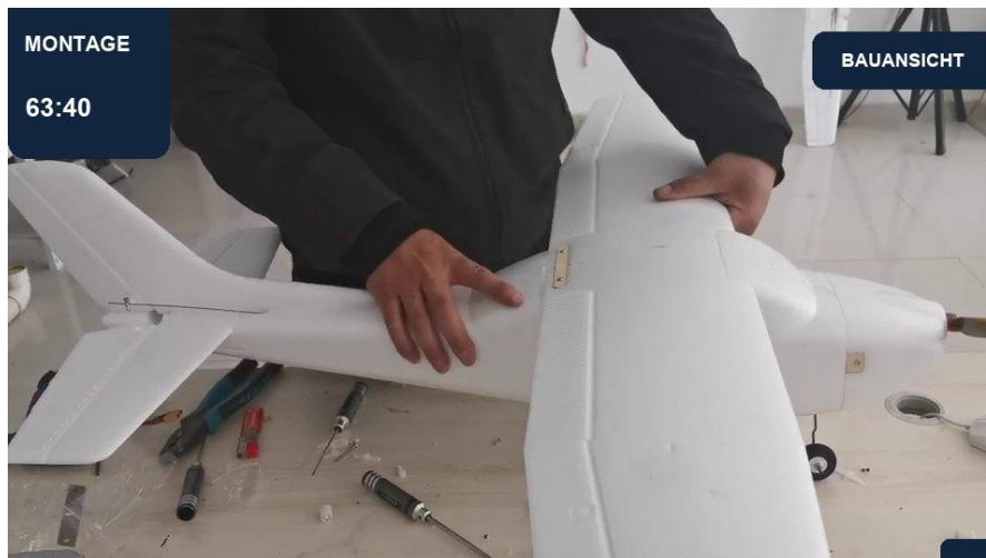
63:40 | Tragfläche auf dem Rumpf befestigen | Ansicht 2
