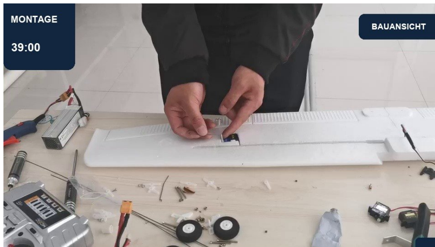
39:00 | Querruderhörner befestigen | Ansicht 2
