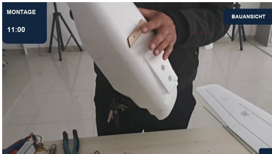
11:00 | Hauptfahrwerksauflage ausrichten | Ansicht 2
