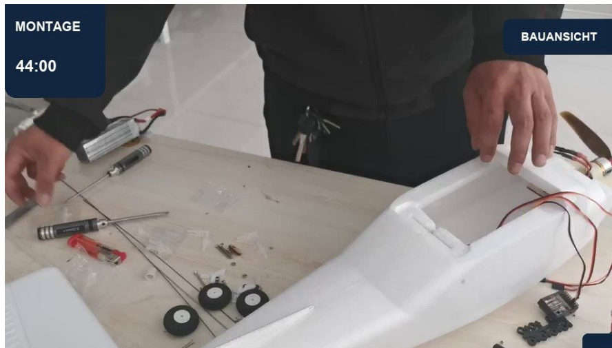
44:00 | Lange Heckgestänge einziehen | Ansicht 1
