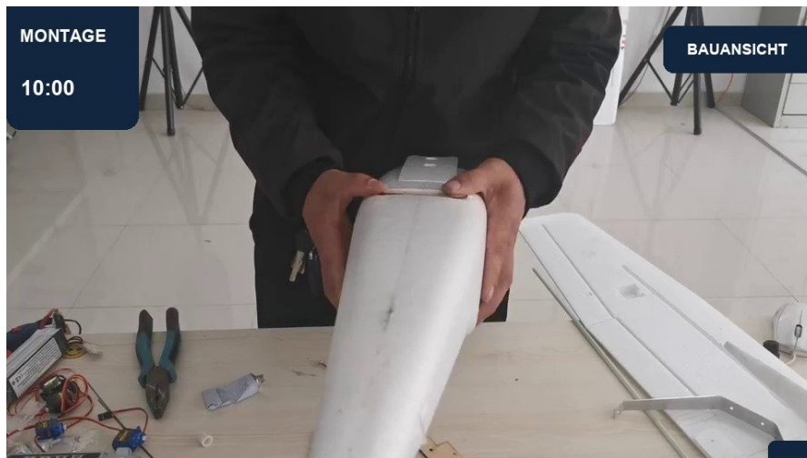
10:00 | Innere Rumpfverstärkung einkleben | Ansicht 2
