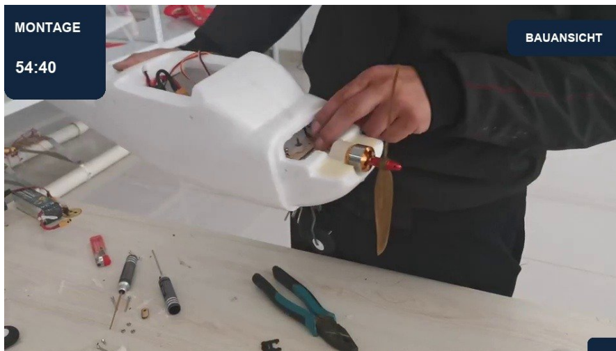
54:40 | Bugrad mit Seitenruder koppeln | Ansicht 2
