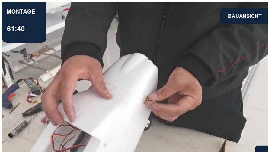
61:40 | Motorhaube anschrauben | Ansicht 1
