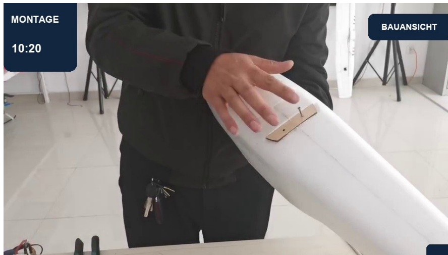
10:20 | Hauptfahrwerksauflage ausrichten | Ansicht 1
