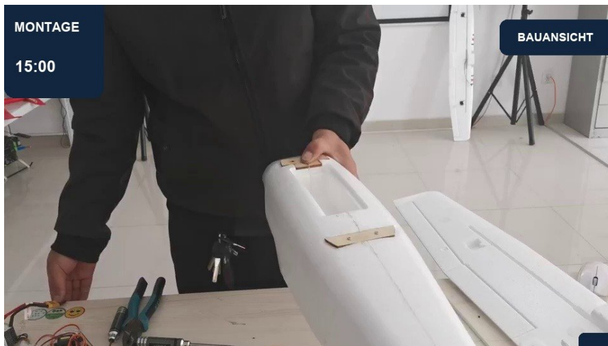
15:00 | Bugfahrwerksaufnahme verstärken | Ansicht 2
