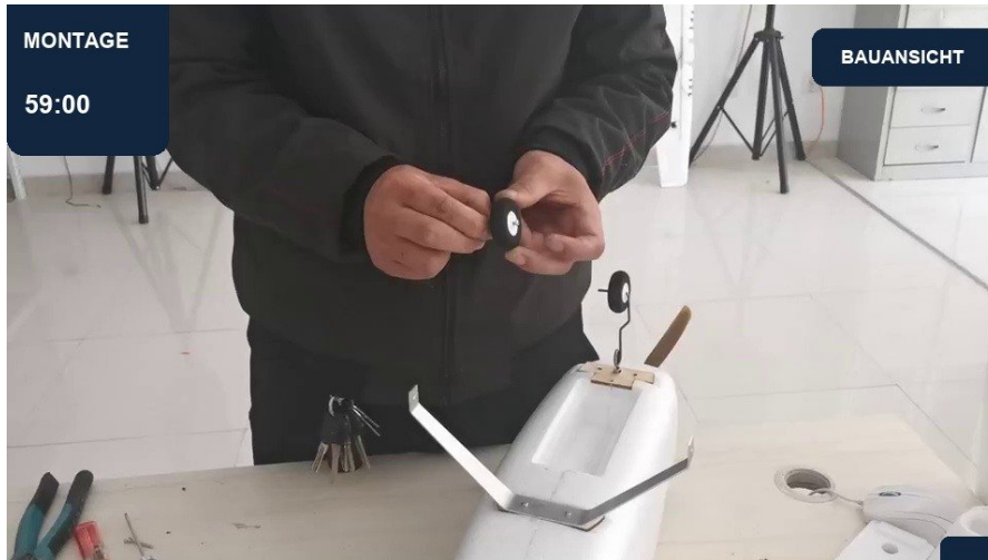
59:00 | Haupträder einsetzen | Ansicht 1
